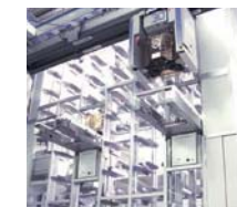
Sistemas automatizados de manuseio de materiais para salas limpas -AMHS para fabricação de semicondutores -MCS (sistemas de controle de materiais)
