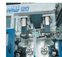
Máquinas-ferramentas - Torno CNC de fuso duplo - Máquina de Torneamento CNC de Fuso Duplo em Linha Oposta
