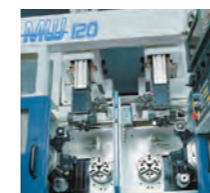
Macchine utensili - Autocentrante CNC a doppio mandrino - Torni CNC a due mandrini contrapposti in linea
