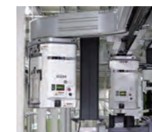
Impianti automatizzati di movimentazione materiali per camere bianche - AMHS (sistema automatico di trasporto wafer e materiali) per gli stabilimenti di produzione di semiconduttori - MCS (sistemi di controllo materiali)
