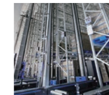
Sistemas logísticos/ sistemas de automatización de fábricas -Sistemas de almacenamiento y recuperación automatizados (SA/SR) -Sistema de clasificación
