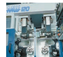
Werkzeugmaschinen - Doppelspindel-CNC-Futterdrehmaschine - In-line-Gegendoppelspindel-CNC-Drehmaschine
