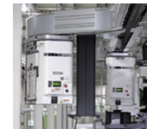
Temiz Odalar için Otomatik Malzeme İşleme Sistemleri -Yarı İletken Üretimi için AMHS (Automated Material Handling Systems) -MCS (Material Control Systems) (Malzeme Kontrol Sistemleri)
