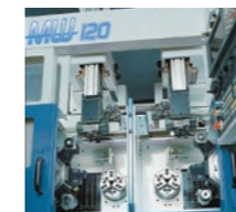
Herramientas de la máquina -Mandrill CNC de husillo doble -Maquina giratoria CNC con dos husillos opuestos
