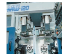
Werkzeugmaschinen - Doppelspindel-CNC-Futterdrehmaschine - In-line-Gegendoppelspindel-CNC-Drehmaschine
