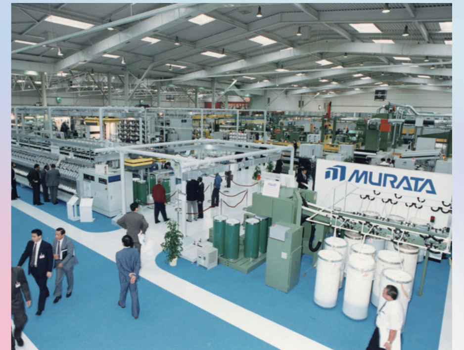
Veniva presentata una macchina trafilatrice e veniva offerta la funzione di trasferimento bobine. Veniva anche dimostrata la connessione del nastro cardato.
