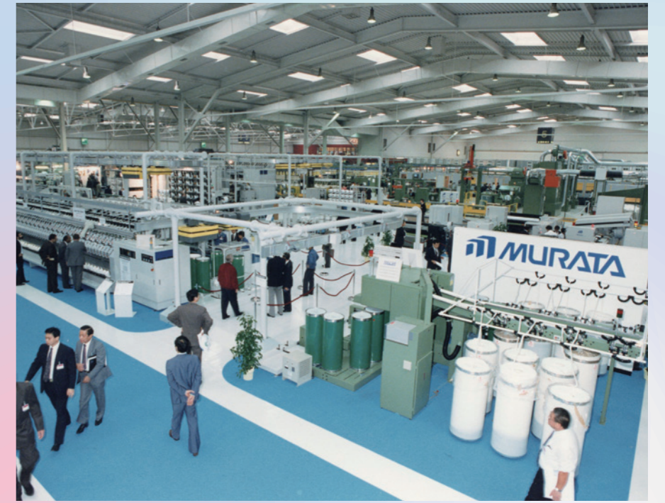
Es wurde eine Wickelstreckmaschine vorgestellt und die Spinnkannenübergabefunktion präsentiert. Der Vorbandanschluss wurde ebenfalls demonstriert.
